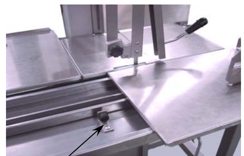
BATENTE TRASEIRO DA MESA MÓVEL NA POSIÇÃO DE LIBERAÇÃO DA RETIRADA DA MESA
